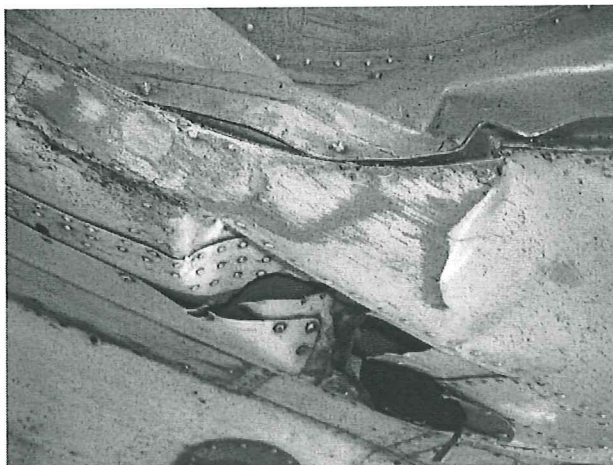
Daños en la bahía del tren de aterrizaje derecho.
